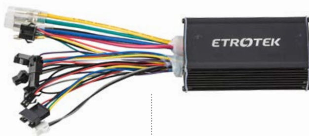
Centralina predisposta con connettori per leve freno e cavi luce
